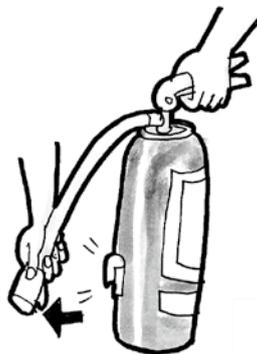
②ホースを外してノズルの先端を持ち火元に向ける。
